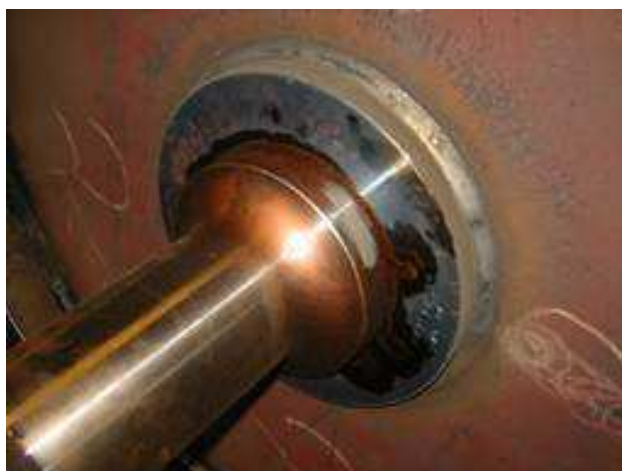
Trommel mit eingeschrumpften Flanschen
